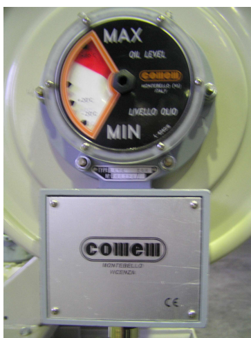
Рис. 5.1 Маслоуказатель стрелочного типа LA14
