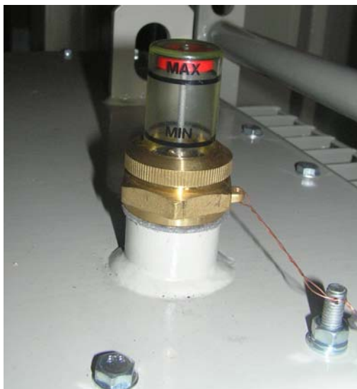
Рис. 7.1 Маслоуказатель поплавкового типа ILRM-1
