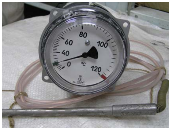
Рис. 7.5 Термометр электроконтактный типа ТКП-100Эк-М1
