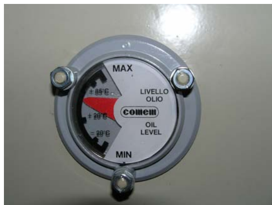
Рис. 7.3 Маслоуказатель стрелочного типа L80
