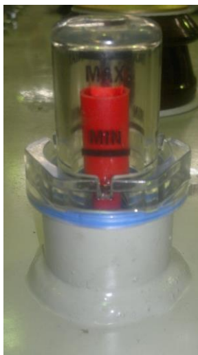
Рис. 7.1 Указатель уровня поплавкового типа СН-45
