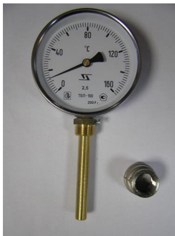
Рис. 7.2 Термометр стрелочный типа ТБП-63
