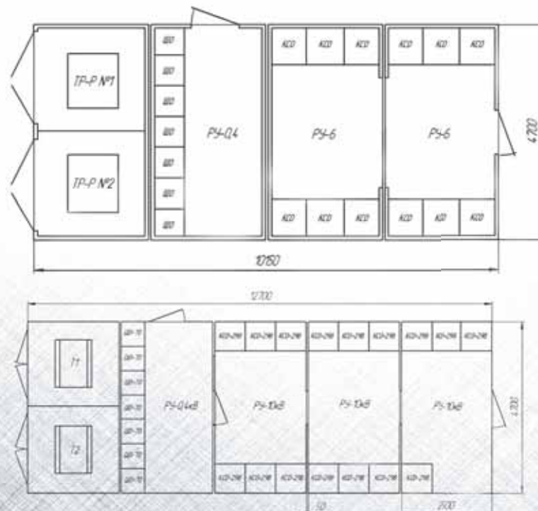
План расположения оборудования 2 БКТП-РП
